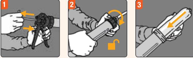
**2:** Schrauben Sie die Injektionskappe der Injektionspistole ab.
