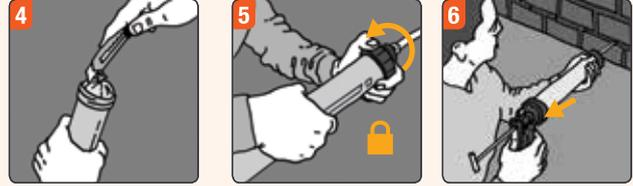
**08** Führen Sie das Injektionsrohr bis zum Ende des Bohrloches ein und füllen Sie das Bohrloch vollständig mit Silicores RX80 Gel,
