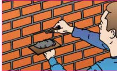
03 Schlechte Verfugungen, Risse usw. müssen zuvor instandgesetzt werden. Bei frisch verfugtem Mauerwerk muss man 8 Tage verstreichen lassen, bevor man **Silcores® HG30** anwendet.
